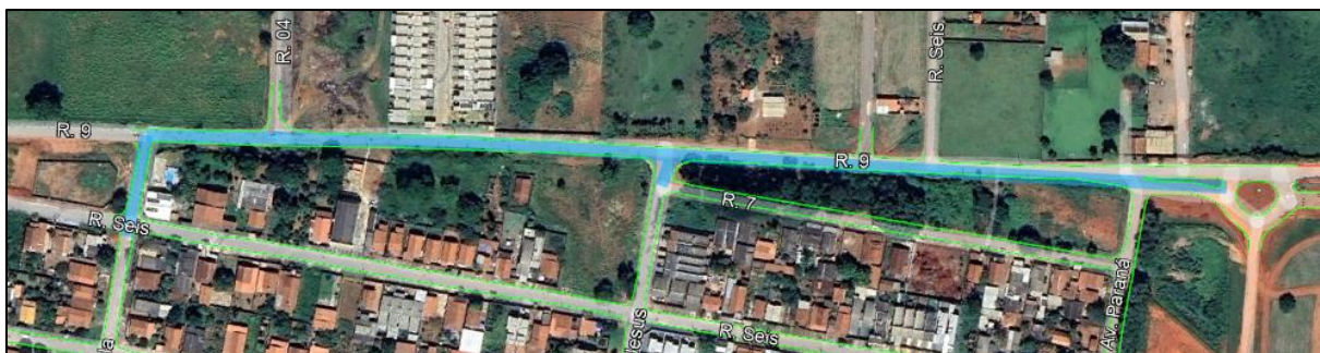
O trecho de projeto é fortemente impactado pelo escoamento superficial recebido das regiões próximas. Por causa dessa realidade o projeto de drenagem contempla intervenções de melhoria na coleta de escoamento superficial e restauração da pista simples a partir da interseção com a Avenida Geralda Maria de Paula até a rotatória após a interseção com a Avenida Paraná, melhorando a coleta do escoamento superficial e direcionando o seu lançamento em local adequado.
