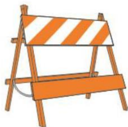
Figura 57: Barreira Móvel com Cavalete Articulado
